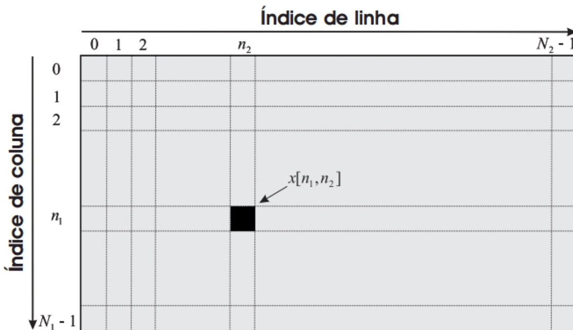
FIGURA 1 - (extraída de OLIVEIRA, 2008) – Ilustração de uma imagem digitalizada e a interpretação das coordenadas das amostras
